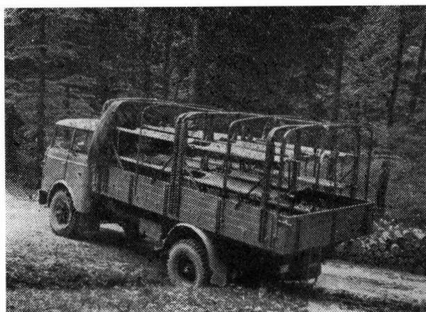
Obr. 5. Pohled na umístění nosítek v nákladním automobilu Škoda 706 RT
