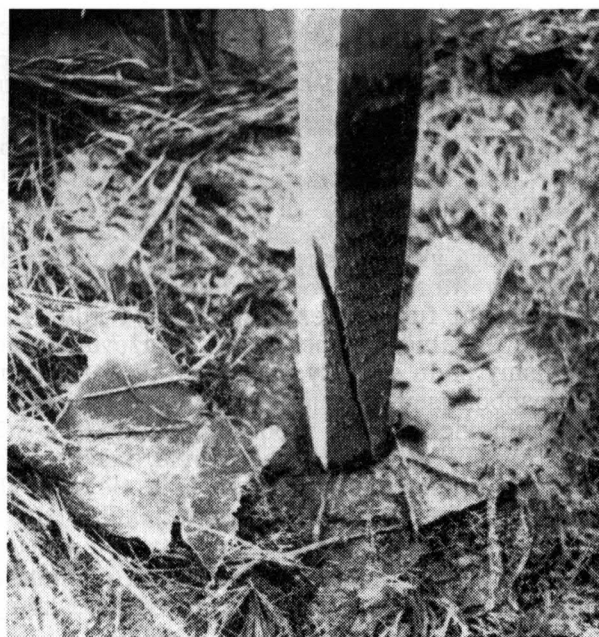
Obr. 4. Poškození hranolu dřeva po odpálení granátu, zbytky granátu v okolí
