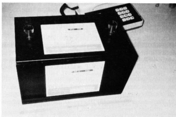
Obr. 1 Odlučovač odpadního zubního amalgamu SG-31 (SKANTECH s. r. o., Hradec Králové)
