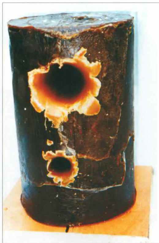
Obr. 4: Fyzikální model části dolní končetiny (stehna) s 2 průstřely (ráže 357 Magnum).
