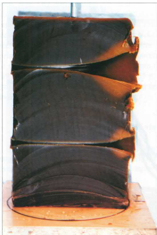
Obr. 5: Podélný řez fyzikálním modelem v místě střelných kanálů od střel ráže 7,62x39.
