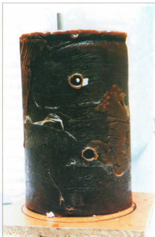
Obr. 6: Fyzikální model části dolní končetiny (stehna) s 2 průstřely (ráže 7,62x39 FMJ).
