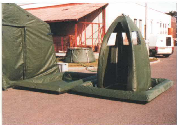
Obr. 1: Pracoviště na dekontaminaci ochranných oděvů. Vpravo sprchová buňka, vlevo sprchová vana pro ležící raněné.
