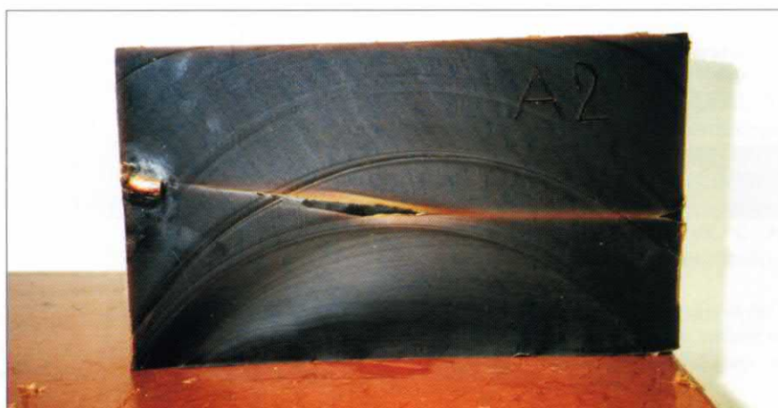
Obr. 4: Podélný řez blokem PP 75/25-IV (A2) v místě střelného kanálu od střely ráže 9 mm Luger ( m_q = 8,02 g; v_d = 359 m/s).
