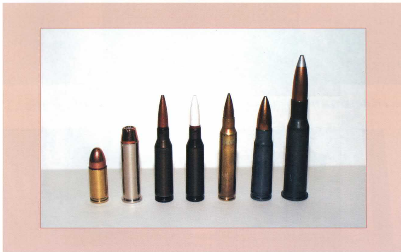
Obr. 2: Sestava kulových nábojů podrobených experimentálnímu zkoumání jejich ranivého účinku. Zleva: 9mm Luger; 357 Magnum (Eldorado); 5,45x39; 5,45x39 cv; 5,56x45; 7,62x39 a 7,62x54 R.
