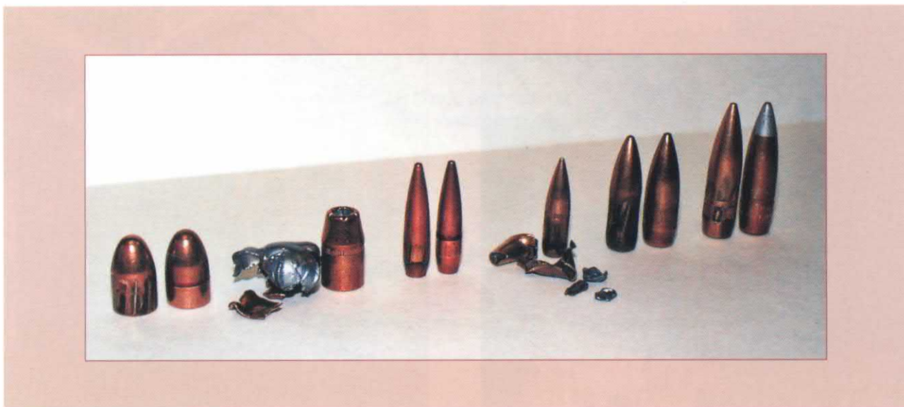
Obr. 6: Porovnání tvaru střel zkoumaných nábojů před výstřelem a po vniknutí do bloku PP 75/25-IV. Vpravo stav před výstřelem střely ze zkušební balistické hlavně, vlevo stav střely po průniku blokem náhradní tkáně.
