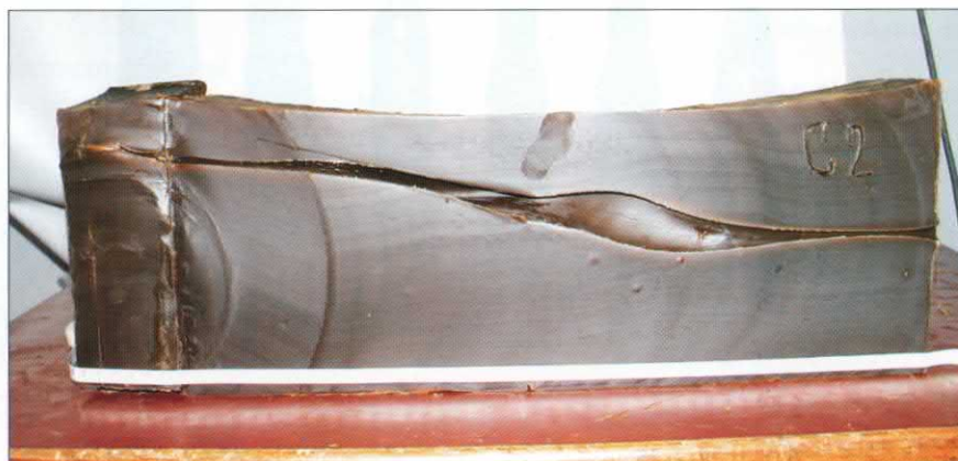
Obr. 5: Podélný řez blokem PP 75/25-IV (C2) v místě střelného kanálu od střely ráže 7,62x39 ( m_q = 7,91 g; v_d = 770 m/s). Je vidět výrazné vybočení osy kanálu od horizontálního směru.
