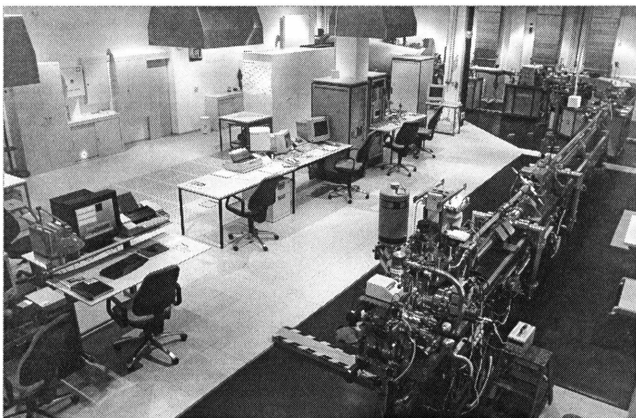
Obr. 1: Na fotografii mikroozařovací laboratoře univerzity v Lipsku je zachycena kolimační soustava nanosondy (vlevo a nahoře) vycházející z válcovitého akceleratoru (nahore uprostřed), který je z větší části překryt ovládacím systémem. V dolním levém kvadrantu se nachází ozařovací komora s automatickým pozičním systémem. Celá konstrukce mikroozařovače je upevněna na desetimetrovém betonovém podloží. Místnost je klimatizována a vstup je povolen za podobných kautel jako vstup na chirurgickou ambulanci.
